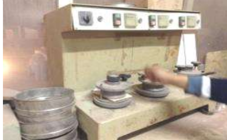
شكل (٣) جهاز قياس مقاومة البلاط للاحتكاك والبرى.
