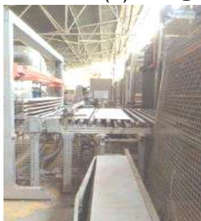
شكل (٥) فرن الحرق لبلاط السيراميك بعد الطباعة
