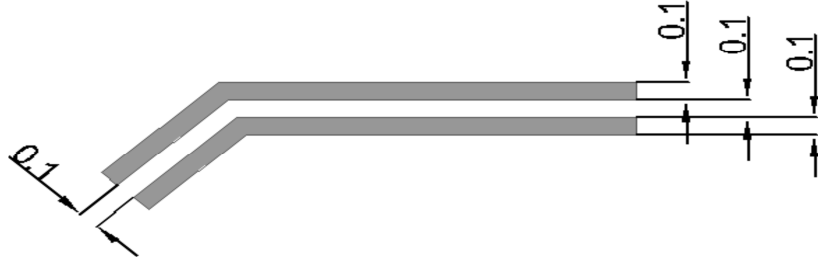
الشكل (٦-١٣) الحد الأدنى لأبعاد الموصلات والفراغات بين خطوط الموصلات
