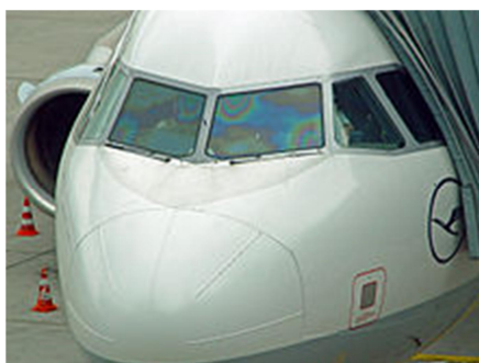
الشكل (٧-٢٧) تكوين المرشحات مزدوجة اللون (٥٦) باستخدام البصريات رقيقة
