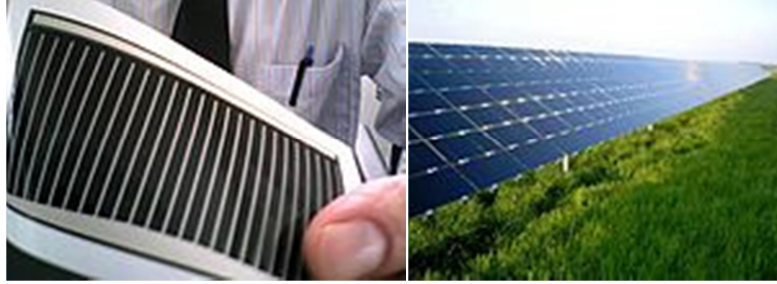
الشكل (٧-٢١) خلايا شمسية من مواد (٤١) نحاس-إنديوم - جاليوم-سليينيد مرسبة على مساند بلاستيك مرنة ولوحات تلوريد صلبة مجهزة على بنية مدعمة
