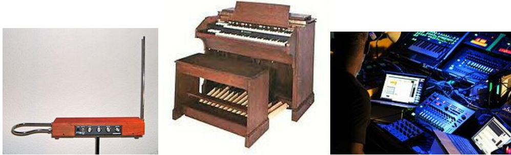
الشكل (٧-٨٥) الهاموند والثيرمين كمثال للآلات المنتجة للصوت باستخدام الوسائل الكهرو ميكانيكية وبالتكنولوجيا الإلكترونية
