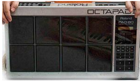
الشكل (٧ - ١١٦) جهاز رولاند تحكم لواجهة الرقمية للآلات الموسيقية
