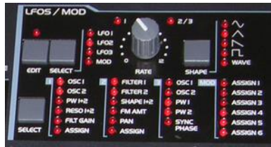
الشكل (٧ - ١٠٦) مقطع من مذبذب التردد المنخفض لأجهزة المزج الحديثة
