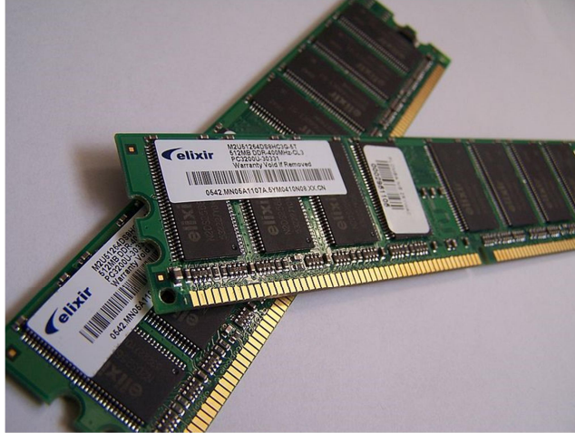
الشكل ( ٦٨-٧ ) وحدات "ذاكرة الوصول العشوائي الديناميكية المتزامنة"،
