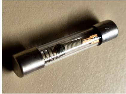
الشكل (٧ - ٤١) مقاومة فيوز كعنصر وقائى لمنع التيار العالى من المرور فى المعدات والأجهزة
